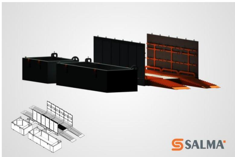
*Plataforma de lavado de 6 metros de longitud, con un tanque de lodos auxiliar y un tanque de decantación de 23.000 litros, dos bombas sumergibles de primera calidad y un cuadro eléctrico IP65 dotado de PLC.*
